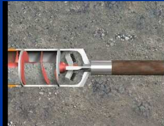
AZ ÜREGES PILÓTARUDAK A VÁGÓÉLNÉL MEGVEZETIK A SAJTOLANDÓ CSÖVET
